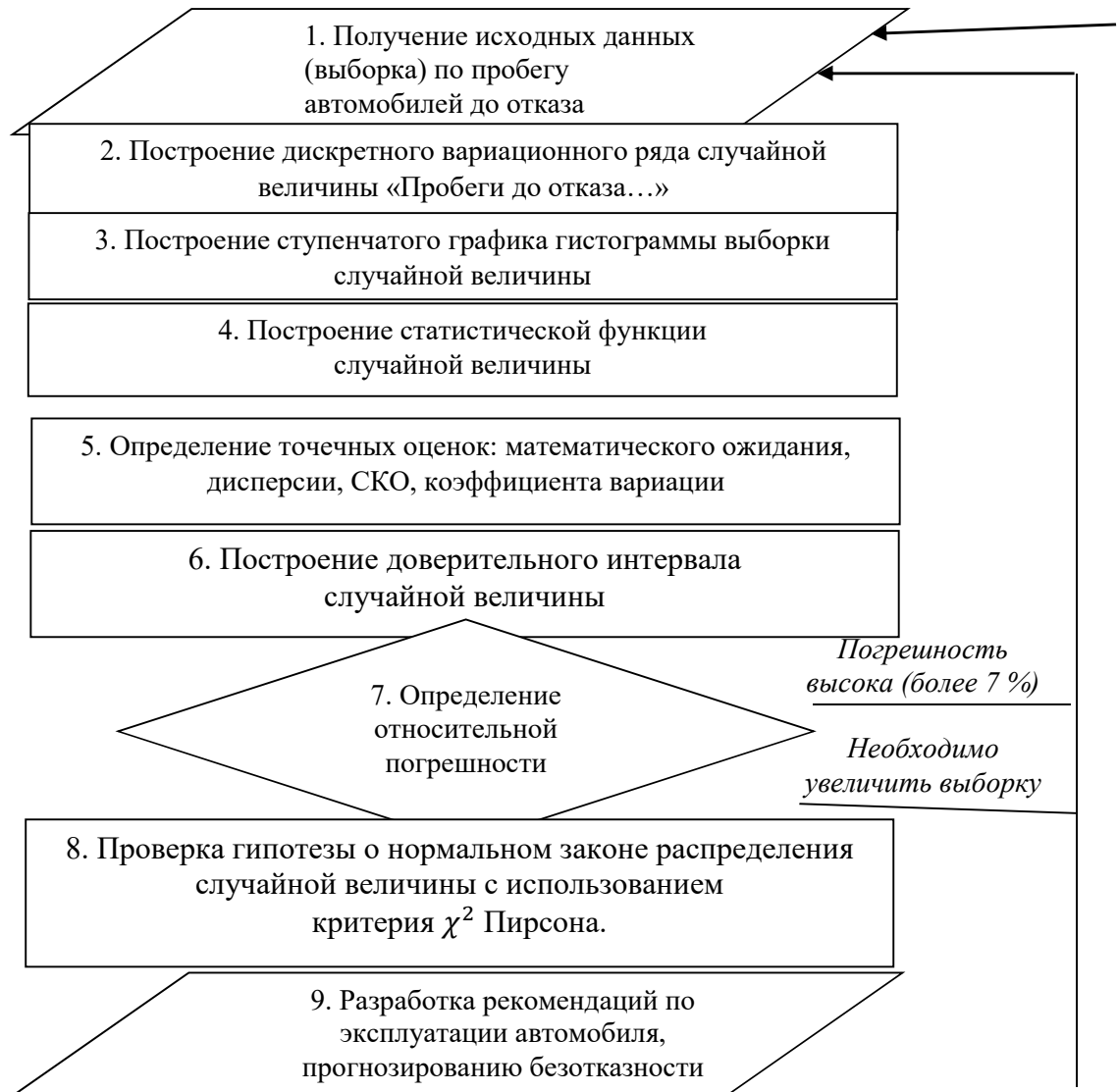
Рисунок 1 – Алгоритм исследования и прогнозирования безотказности автомобилей, основанный на элементах математической статистики
