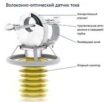
*Рисунок 3 – Волоконно-оптический датчик тока*
