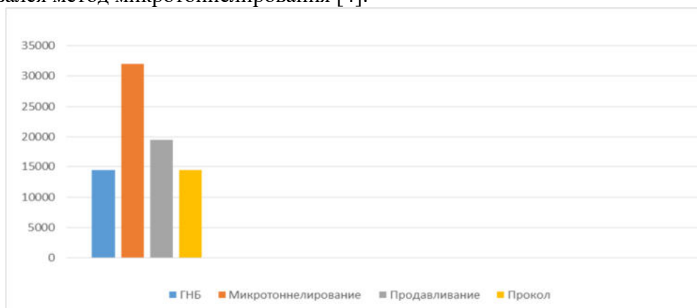
Рисунок 1 – Диаграмма сравнения стоимости бестраншейных способов прокладки трубопроводов
