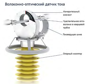
Рисунок 3 – Волоконно-оптический датчик тока
