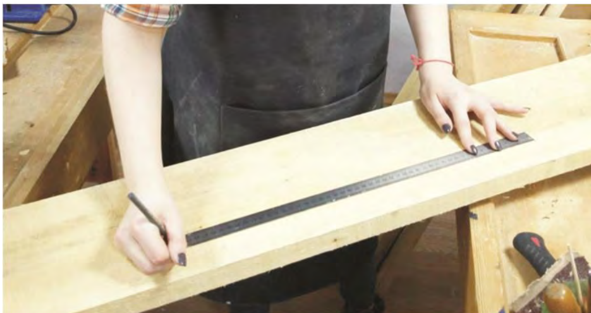
Рис. 1. Разметка модулей на древесине
