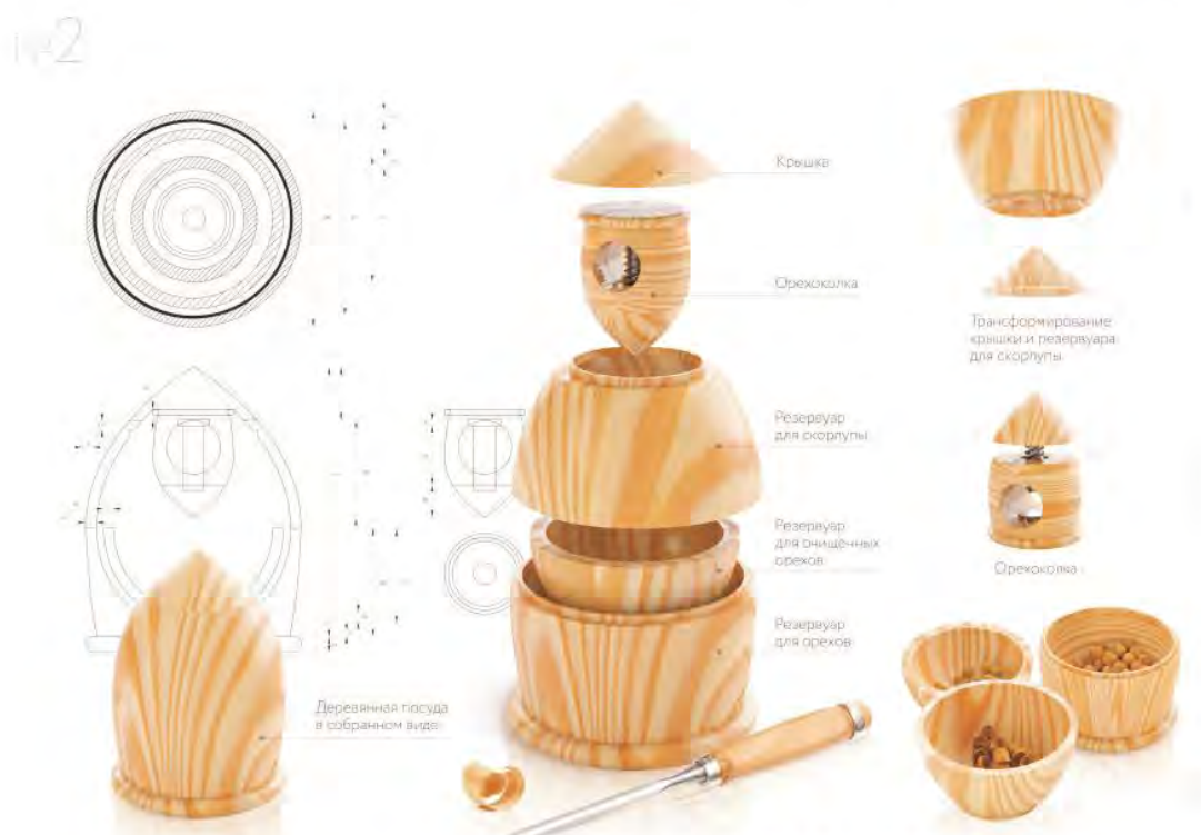
Рис.1. Чертеж и 3-Д модель набора посуды из дерева
