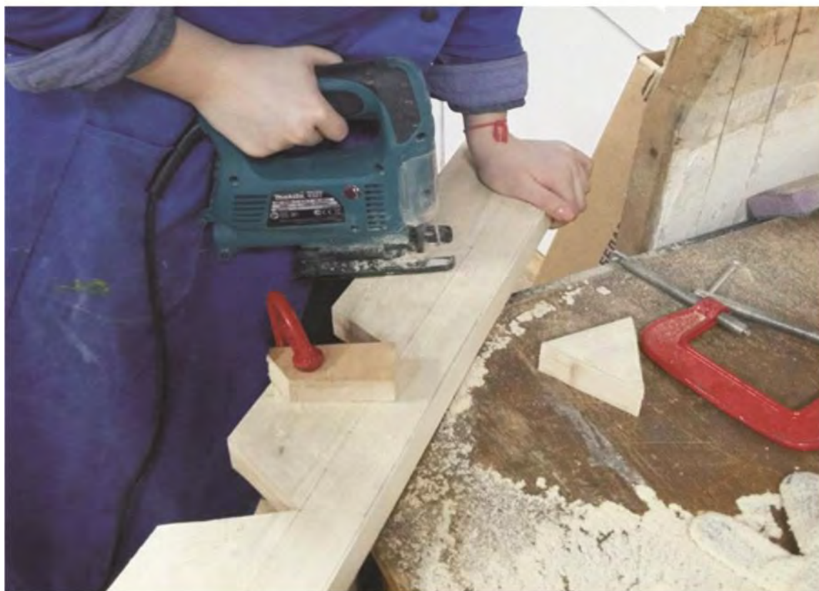
Рис. 2. Подготовка модулей электрическим лобзиком
