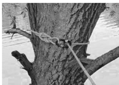
Рисунок 3 – Способ закрепления веревки на дереве с помощью карабинов
